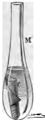
Fig. 260. Matras d'essayeur avec son acide et son cornet d'or.
